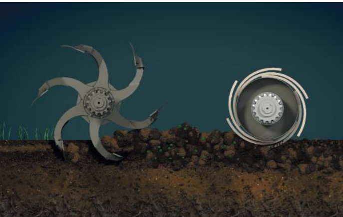
◀ Stroj za obradu s pogonjenim valjkom za pjeskovita tla i ilovaču
